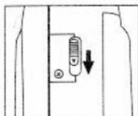
1 Öffnen Sie die Kamerarückwand indem Sie die Rückwandriegelung nach unten schieben.
